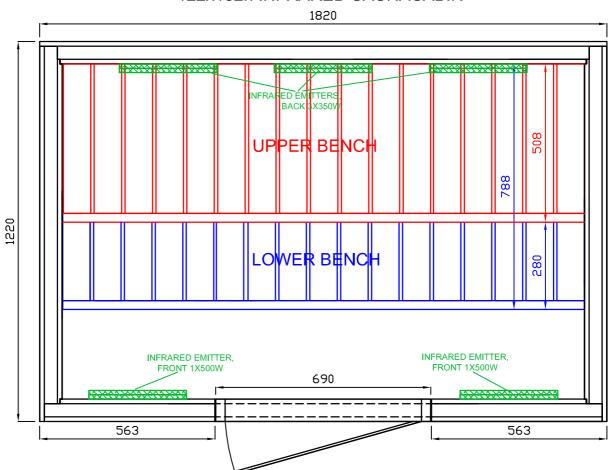
122x182h INFRARED SAUNACABIN CONTAINS 2x250W INFRARED EMITTERS FOR THE LEGS (LOCATED BETWEEN UPPER AND LOWER BENCH MODULE IN THE BACK WALL)
